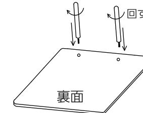
【側面図】必要に応じて②脚部ポールを取り付け、角度・高さを調整して使用してください。
