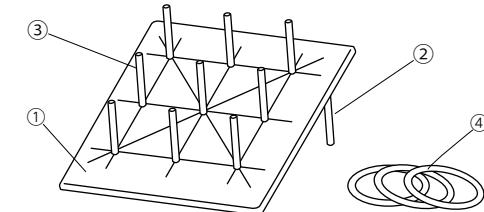
【手順1】①本体ボード部に③得点ポールを取付けします。【手順2】必要に応じて①本体部の裏面に②脚部ポールをゆるみがないよう9カ所取付けてください。【側面図】参照
